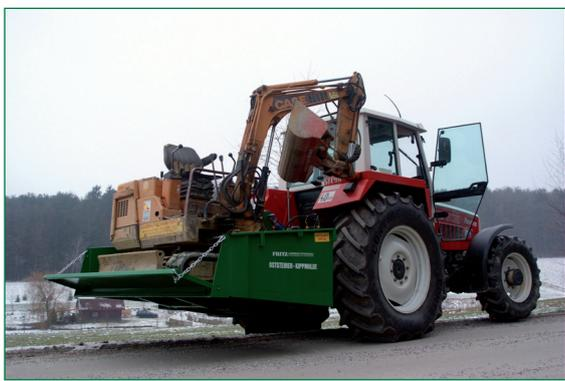
Ausgestattet ist die Kippmulde Super-Duo mit seitlich und vorne eingeschweißten Formrohren für Ecksteher sowie Laschen und Zurrgerät.
