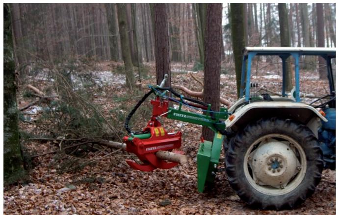
**Die Grundausstattung jeder Forstzange kann jederzeit auf die Komplettausstattung erweitert werden (Modulbauweise d.h. steckbare bzw. schraubbare Verbindungen!)**
