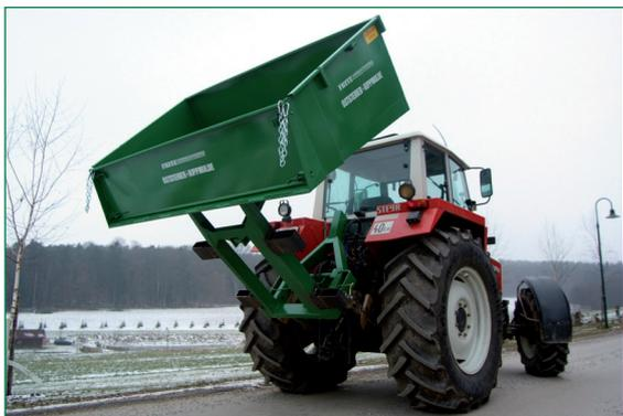
Durch die serienmäßige Hubarmverlängerung und die nach hinten schräg verlagerte Dreipunktanhängemöglichkeit, kann in Verbindung mit einem hydraulischen Oberlenker eine Abkipphöhe von 1,80 bis 2,20 m erreicht werden.
