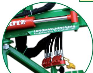
Großer Schwenkzylinder mit Schutzblech, Absteckhalterung für Schläuche oder Steuerblock
