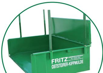
Seitliche Formrohre für Ausatzwände.
