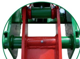
Sehr hohe Stabilität durch innenliegende und durchgehend verschraubte Greifarme
